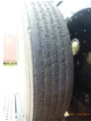
Llanta de repuesto con desgastes en huellas
