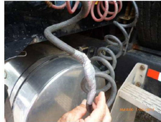
Cables con reparaciones improvisadas
