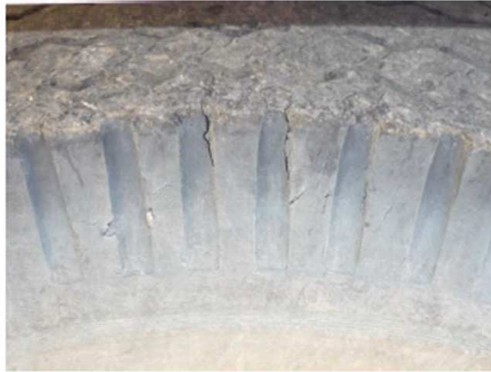
Llanta con rajaduras
