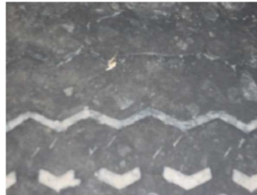
Llanta desgastada de forma no uniforme
